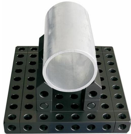
2 Deltablöcke lassen sich zu einem Prisma zusammensetzen. Konische Teile lassen sich durch Schrägstellung horizontal ausrichten.
