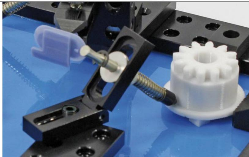
Die federnde Schubstange ermöglicht eine Positionierung im Winkel
