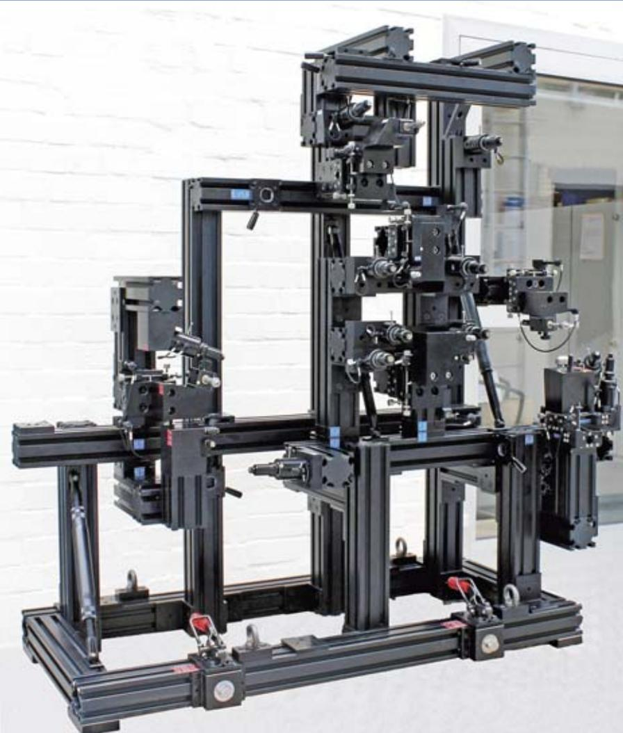
ALUQUICK Vorrichtung für die Fixierung eines Radhauses, Sonderanfertigung aus Profilen ohne Raster
