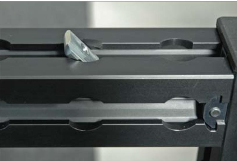
▲ALUQUICK T-Nutsteine können in gerasterte Profile eingesetzt werden. Dieses ist besonders praktisch, wenn die Stirnseiten des Profiles nicht mehr zugänglich sind.
