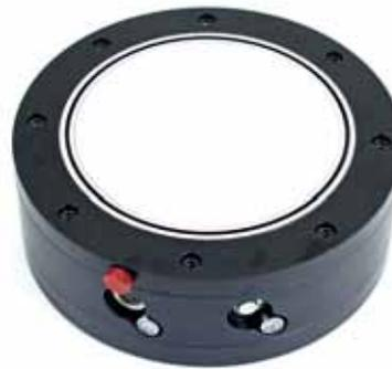
Autarkes Vakuum-Spannfutter. Losgelöst von allen externen Versorgungen können Werkstücke mittels Vakuum gespannt werden. Akkus, Vakuumpumpe, Anzeige- Überwachungsgeräte und Ventile sind integriert
