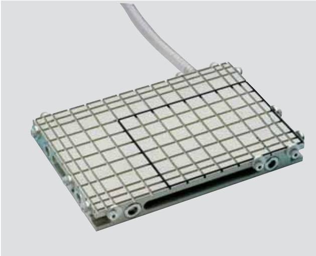
Aufspannturm für ein Bearbeitungszentrum mit 6 St. Vakuum-Spannplatten, integrierte Speicher, Ventile und Drucksteuerung.
