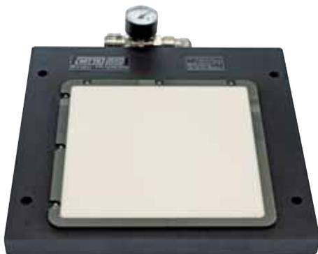
Feinstgefrästes Vakuum chuck zum Spannen von Wafern. Spannfläche aus mikroporösen Werkstoff Witte MP CE100 WHITE. Plangenaugigkeit < 0,005mm
