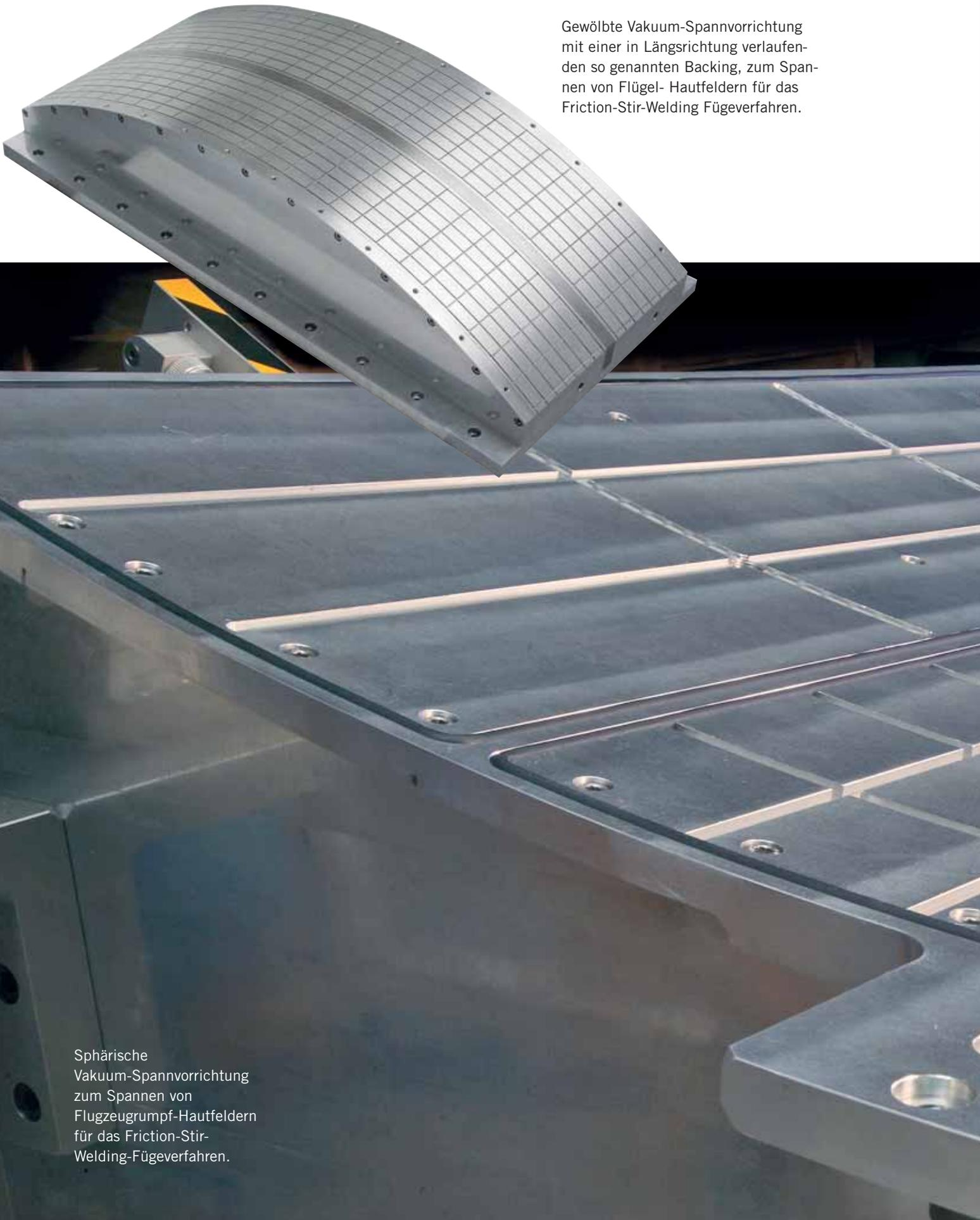
Gewölbte Vakuum-Spannvorrichtung mit einer in Längsrichtung verlaufenden so genannten Backing, zum Spannen von Flügel-Hautfeldern für das Friction-Stir-Welding Fügeverfahren.
