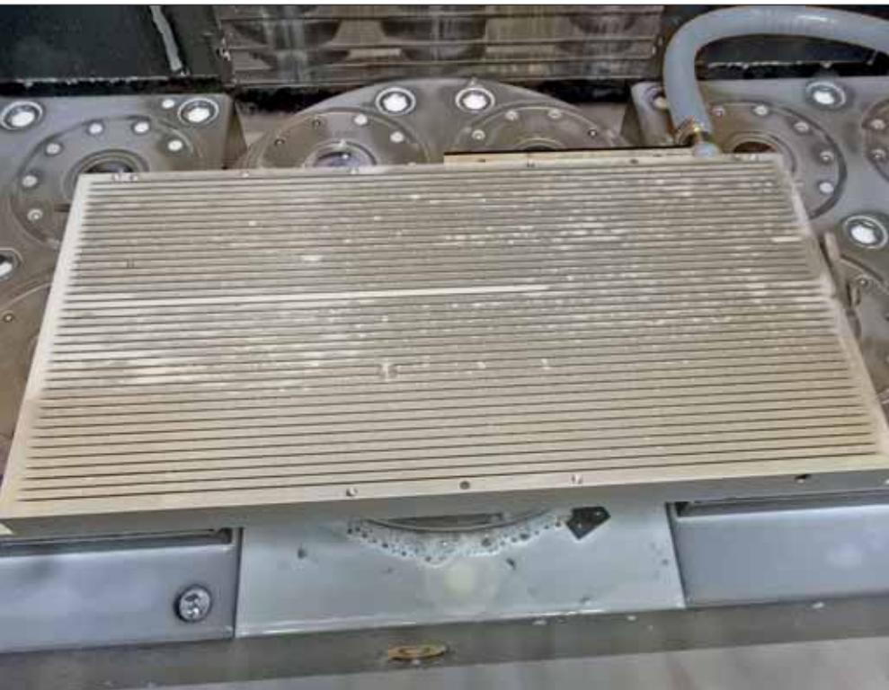
Schlitz-Vakuum-Spannplatte gespannt auf einem Nullpunktspannsystem.
