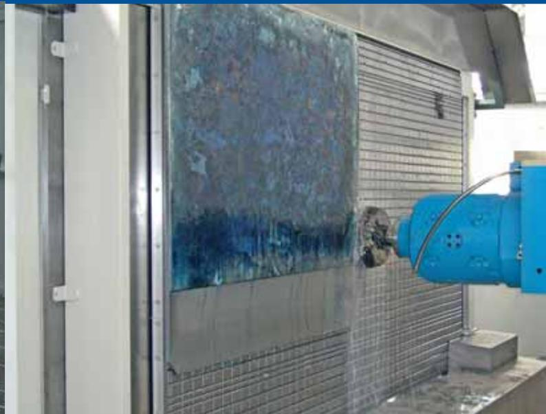
Stahlwerkstück in vertikaler Ausrichtung vakuumgespannt, Werkstückgewicht 400kg
