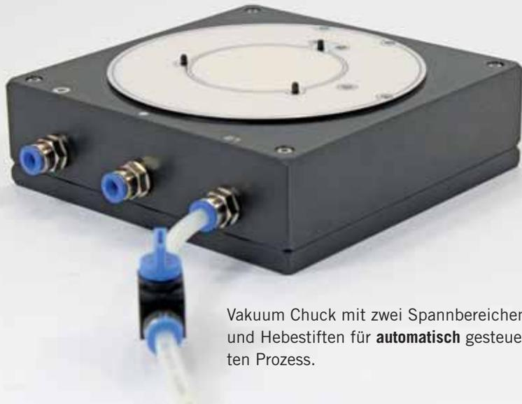
Vakuum Chuck mit zwei Spannbereichen und Hebestiften für **automatisch** gesteuerten Prozess.
