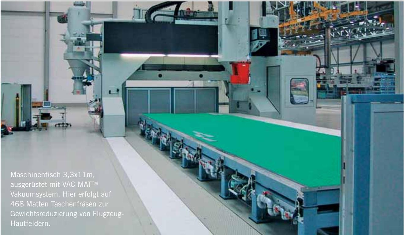
Maschinentisch 3,3x11m, ausgerüstet mit VAC-MAT™ Vakuumsystem. Hier erfolgt auf 468 Matten Taschenfräsen zur Gewichtsreduzierung von Flugzeug-Hautfeldern.
