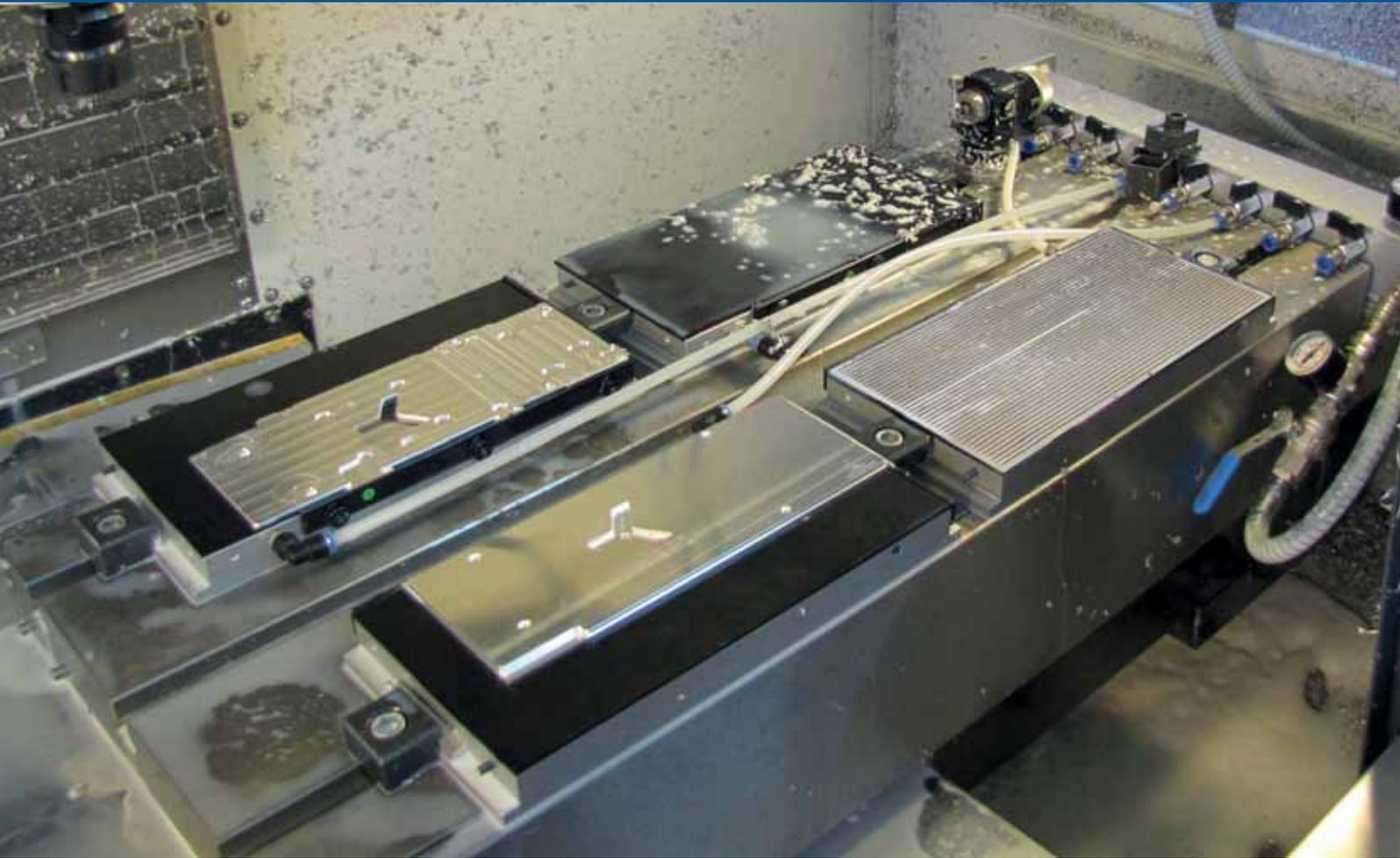
4 Schlitz-Vakuump-Spannplatten in der Produktion, bei der Herstellung von Aluminiumträgern.
