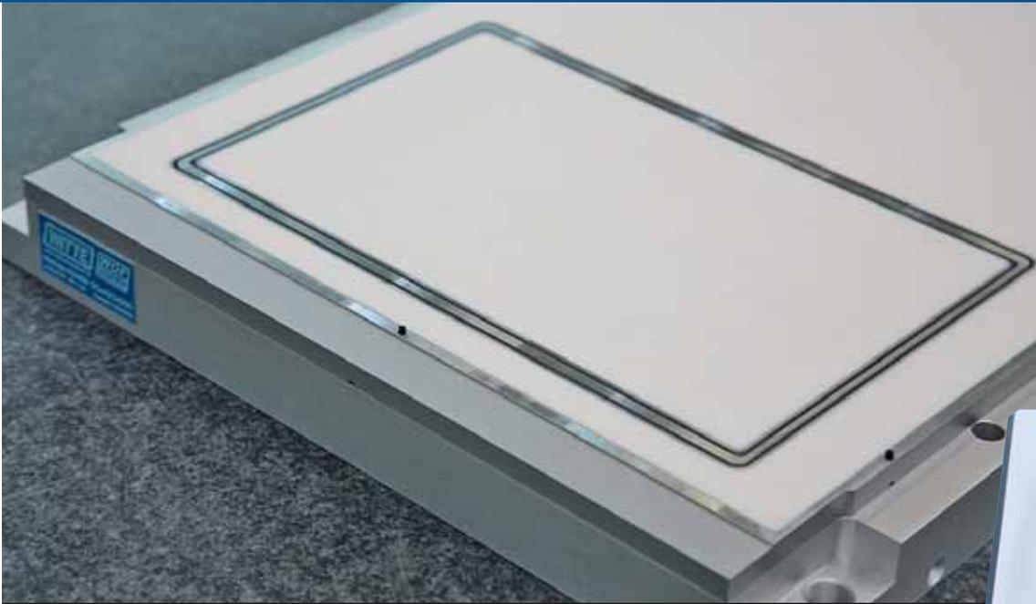
Vakuum- Spannsystem für Laseranwendungen. Der Bildausschnitt zeigt die beiden Spannbereiche und die Schneidkanäle.
