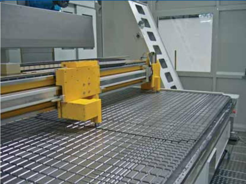
NC gesteuertes Anschlagssystem auf einer Vakuum-Spannplatte für reproduzierbare Aufspannungen.
