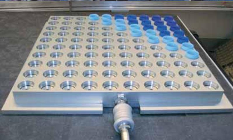
Vakuum- Spannplatte zum Spannen von Getränkeverschlüssen beim Messvorgang auf Koordinaten-Messmaschinen.
