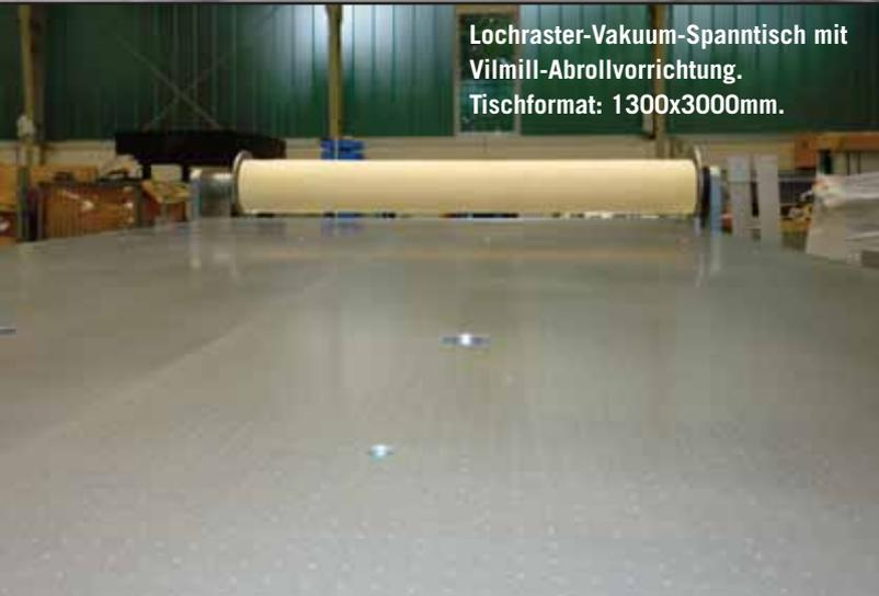
Lochraster-Vakuum-Spanntisch mit Vilmill-Abrollvorrichtung.
