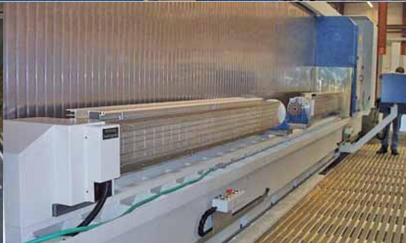
Horizontale Wendespanner 300x3500 mm mit Vakuum - Spannplatten auf 4 Seiten zur Aufnahme von Alu-Profilen.
