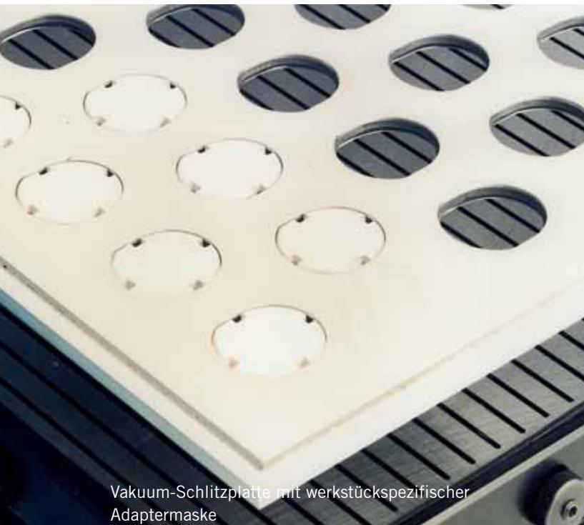
Vakuum-Schlitzplatte mit werkstückspezifischer Adaptermaske
