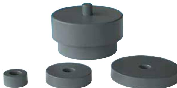
Anschlag- und Positionier-Pods ermöglichen präzises und wiederholgenaues positionieren des Werkstückes. Die FLIP-POD™ Anschläge werden nach dem Anschlagen des Werkstückes beim Beaufschlagung der Flip-Pods mit Vakuum automatisch in die Pod-Platte zurückgezogen und schaffen somit genügend Freiraum für die Bearbeitung.
