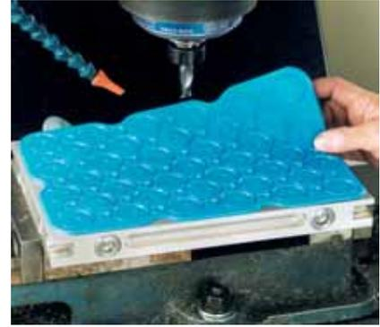
Die Führungsnoppen auf der Unterseite gewährleisten die schnelle und genaue Positionierung der VAC-MAT™ auf der Vakuumplatte
