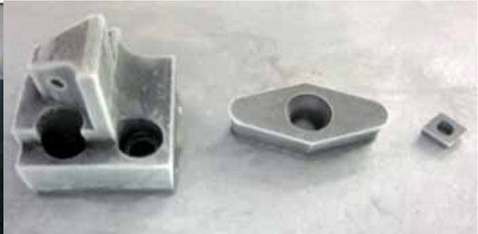
Beim Spannen mit dem ICEVICE®-System werden die Werkstücke auf der Spannplatte mittels eines kapillaren Wasserfilms für die Bearbeitung festgefroren. Auch relativ unebene Werkstücke werden angefroren, da die Spalten mit Wasser gefüllt werden.
