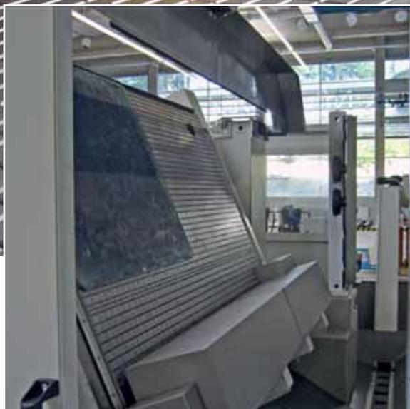
Hydraulisches Einschwenken des Kipptisches von der horizontalen in die vertikale Position
