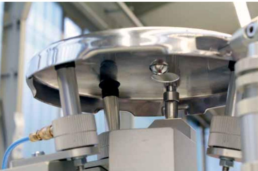
Schnelles Spannverfahren für komplex geformte Bauteile
