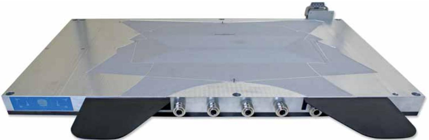
Vakuum- Spannplatte ohne gespanntes Lederwerkstück.
