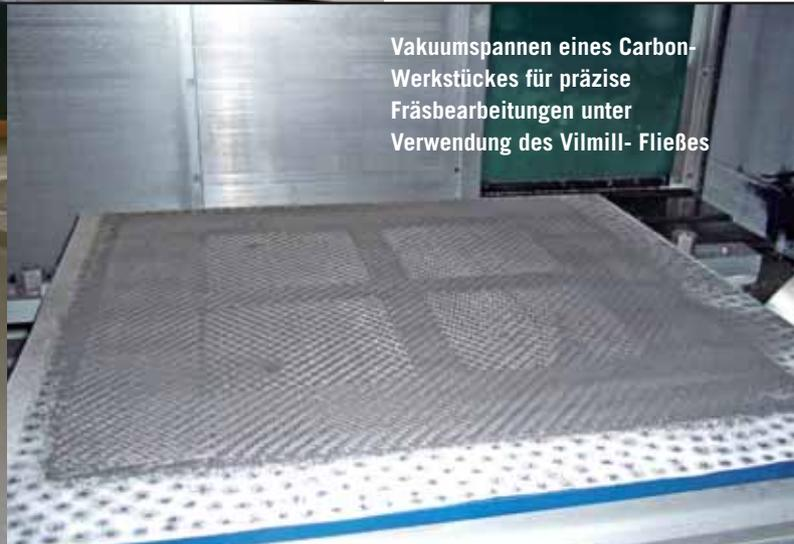
Vakuumspannen eines Carbon-Werkstückes für präzise Fräsbearbeitungen unter Verwendung des Vilmill- Fließes
