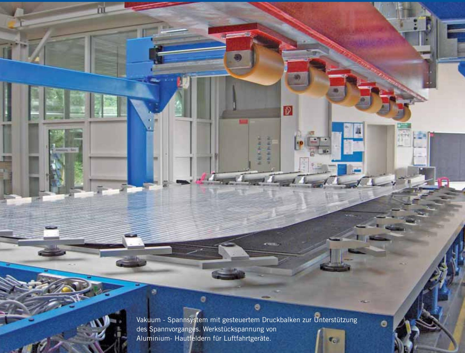
Vakuum - Spannsystem mit gesteuertem Druckbalken zur Unterstützung des Spannvorganges. Werkstückspannung von Aluminium- Hautfeldern für Luftfahrtgeräte.
