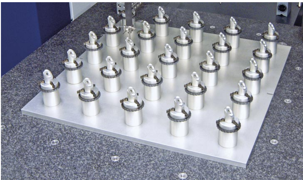
Anwendungsbeispiel für Handspannfutter: 25 3-Backen-Handspannfutter in einer Messvorrichtung.
