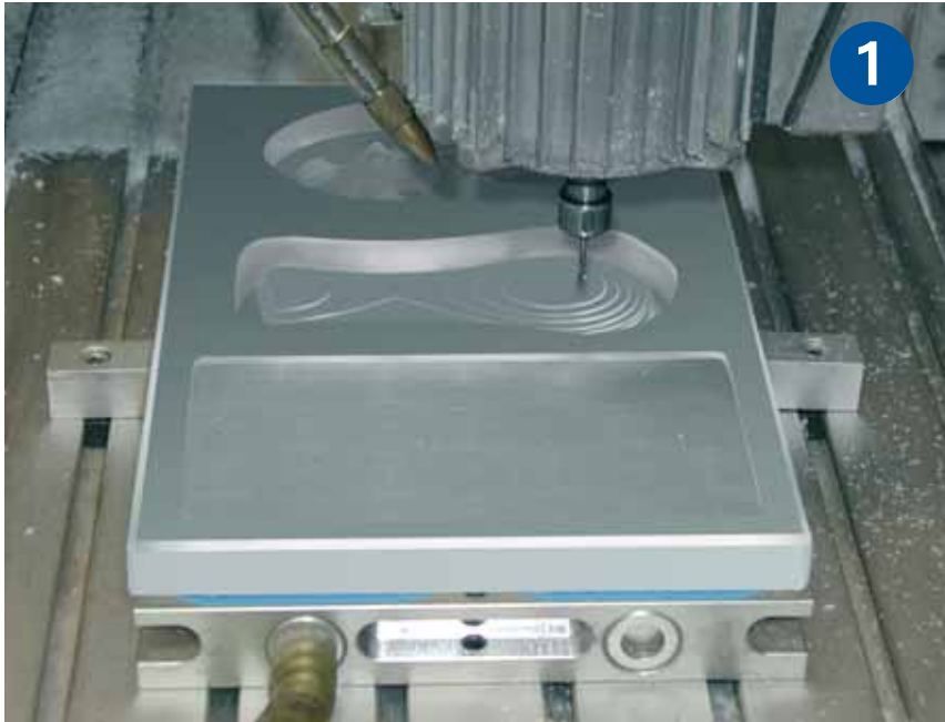
Links Im ersten Schritt wird das Werkstück wie gehabt halb ausgefräst.
