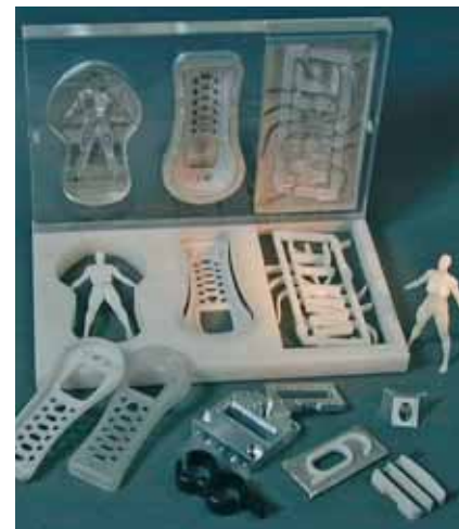
Das Witte Weiguss Verfahren eignet sich besonders für kompliziert/sphärisch geformte Werkstücke
