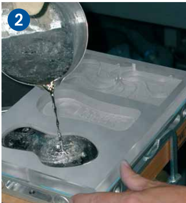
Rechts Danach wird der ausgefräste Hohlraum mit Witte Weiguss Gießmasse wieder aufgefüllt
