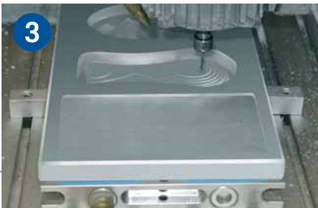
Rechts Nach dem Erstarren der Masse wird das Werkstück gewendet und von der anderen Seite her fertiggestellt
