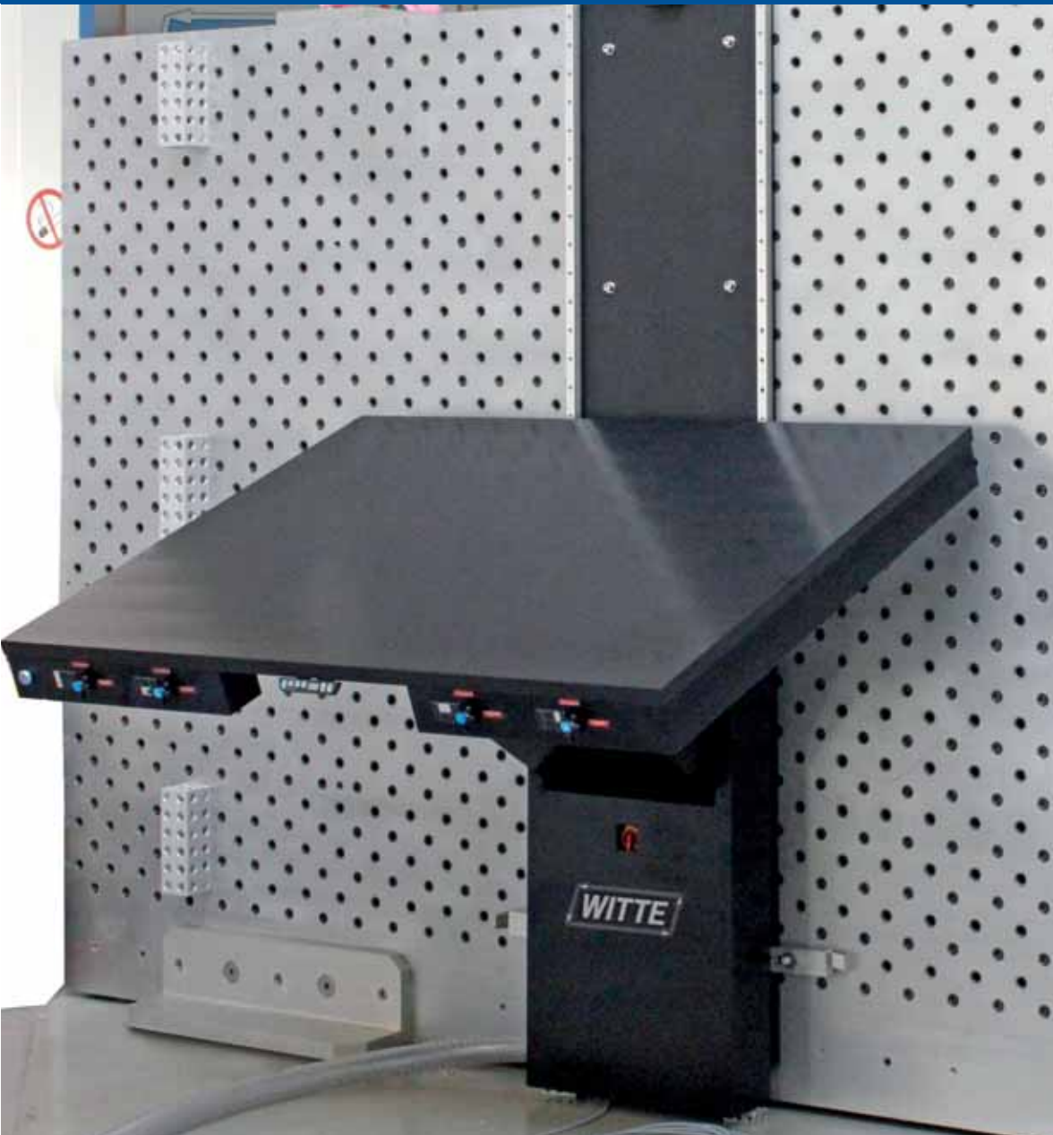
Lochraster-Vakuum-Spanntisch mit Vilmill-Abrollvorrichtung. Tischformat: 1300x3000mm.
