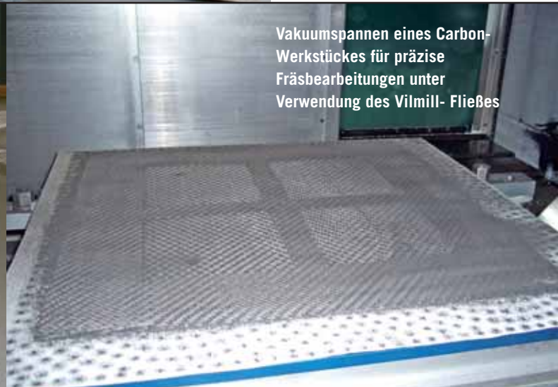
Lochraster-Vakuum-Spanntisch mit Vilmill-Abrollvorrichtung. Tischformat: 1300x3000mm.
