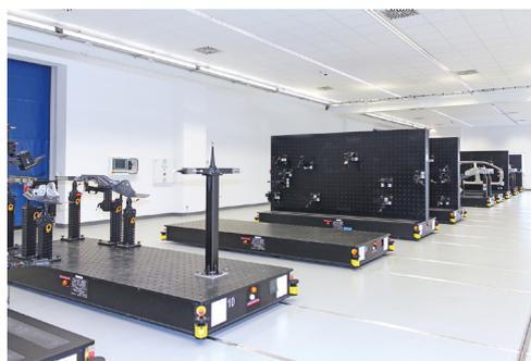
*Die präzisen und stabilen FixBase-Strukturplatten dienen als Basis für Messaufnahmen beziehungsweise Vorrichtungen, als Ersatz für Ausleger-KMG-Messtische sowie als Transportplatten und kubische Aufspannkörper mit fünf Nutzflächen.*
