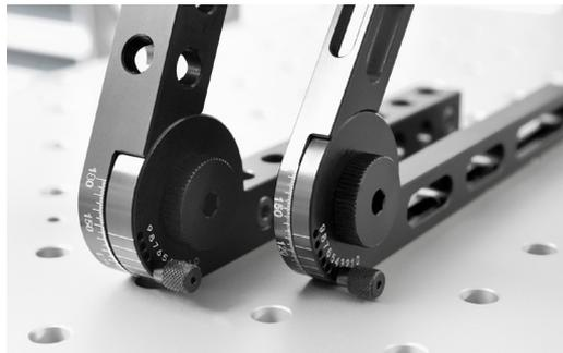
*Die neuen Verstellwinkel mit Skala und Nonius-Absteckraster in 1-Grad-Schritten versprechen gleichzeitig unkomplizierteres, schnelleres und genaueres Ausrichten beziehungsweise Anschlagen von Werkstücken.*
