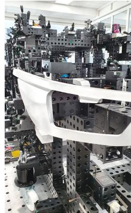
*Ab Spätherbst stellt Witte das gesamte Teilesortiment seines modularen Spannsystems ALUFIX sukzessive auf standardmäßig schwarze Eloxierung um. Damit ist das Spann- und Fixiersystem noch besser auf den zunehmenden Einsatz optischer Messverfahren eingerichtet.*
