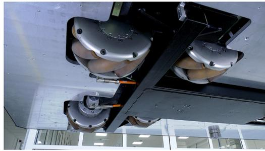
*Modulares Antriebskonzept mit acht Mecanum-Rädern pro Fahrwerk – davon vier angetrieben – auf je zwei luftgelagerten Fahrwerkschwingen.*
