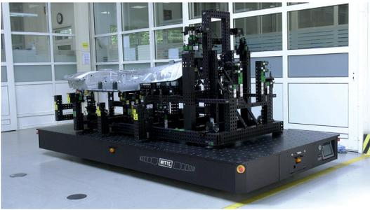
*Mit der multidirektional steuerbaren Strukturplatte FixBase MDD stellt der deutsche Spannsystemspezialist Witte seine neueste Lösung für die vollautomatisierte mobile Messraumbestückung und Beladeprozesse vor.*
