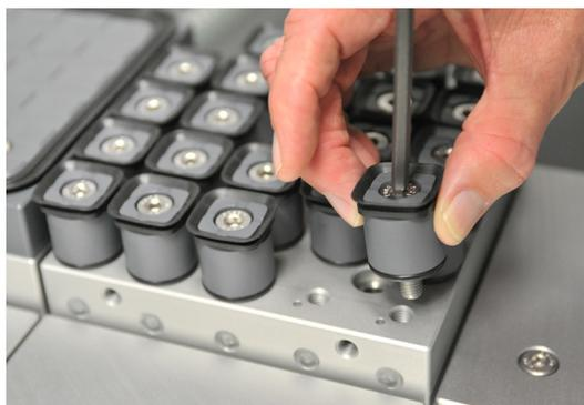
*Das flexibel konfigurierbare Vakuum-Spannsystem „QuadroVac“ von Witte ist speziell für profilreiche und in vielen Achsen zu bearbeitende Werkstücke ausgelegt. Einsatzgebiete von „QuadroVac“ sind vor allem das Fräsen, Bohren und Gewindeschneiden an kleinen bis mittelgroßen Werkstücken aus Holz, Kunststoff, Glas oder Metall, zum Beispiel an Gussteilen. Auch an solchen mit Abstufungen, Taschen oder Durchbrüchen.*
